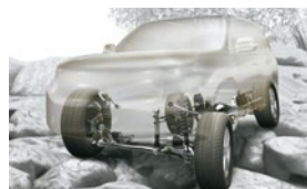
Sistema de suspensión Kinetic Dynamic (KDSS)
