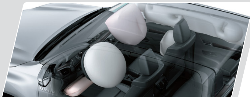
7 airbags: frontales (x2), de rodilla (conductor), laterales (x2) y de cortina (x2)
