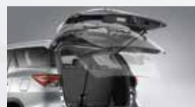
Portón trasero con sistema de apertura y cierre eléctrico.*
